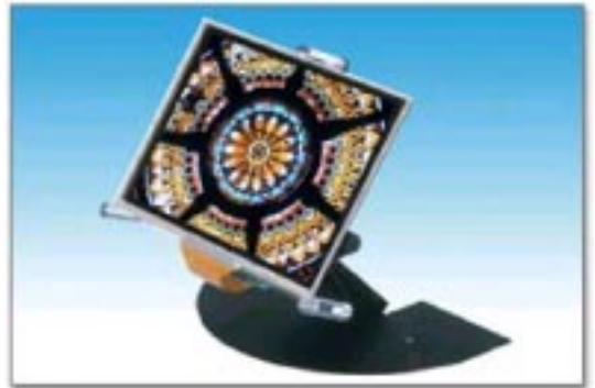
〈그림 6〉 Sanyo와 Eastman이 2000년 5월에 공동개발한 5.5인치 Active Matrix 유기 EL 디스플레이
